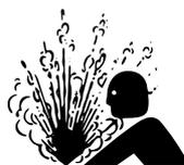
**Risque d'explosion de l'huile hydraulique - Isolez l'accumulateur hydraulique avant l'entretien**
