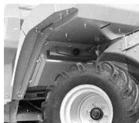
Le verrou de châssis est placé sur le joint d'articulation, sous la base du siège, et est fixé à l'aide d'un boulon.
