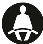
**Ne retirez jamais les structures de sécurité, ne les modifiez jamais ou ne tentez jamais de les réparer.** Si elles sont endommagées, contactez le service. Attachez toujours la ceinture de sécurité afin de rester à l'intérieur de la zone protégée du châssis de sécurité.
