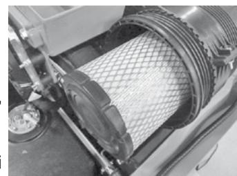
1. Pressez l'évent en caoutchouc sur le couvercle de boîtier de filtre pour évacuer l'eau et la saleté du filtre.
