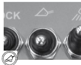
REMARQUE : L'interrupteur est installé sur le tableau de bord, également dans les cas où l'option de flottaison du bras de levage n'est pas installée sur le chargeur. La présence de l'interrupteur ne signifie pas que la flottaison du bras de levage est fixée.
