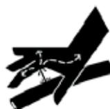
**Ne manipulez jamais des composants hydrauliques si le système hydraulique est sous pression - Risque d'injection de l'huile hydraulique à travers la peau.**
