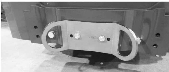
Attachez l'œillet d'arrimage réf. A418623 installé au pare-choc arrière ou au contrepoids
