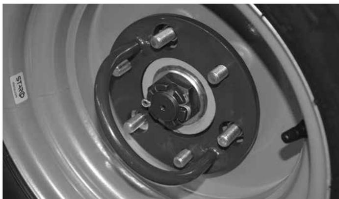
L'œillet d'arrimage sur le moyeu de la roue, réf. A423161
